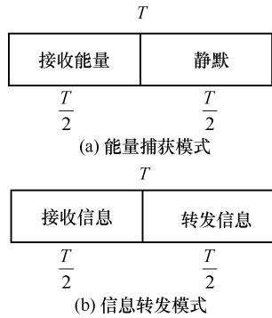
图 2 中继节点的 2 种传输模式
